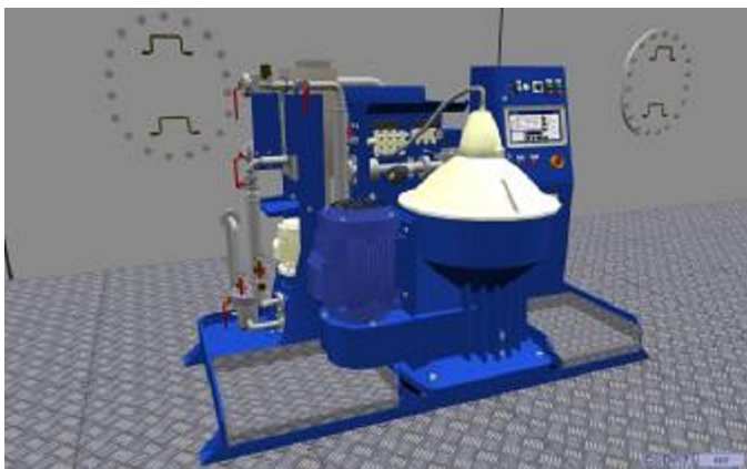
Fig. 11 MED3DH– fuel separator module
